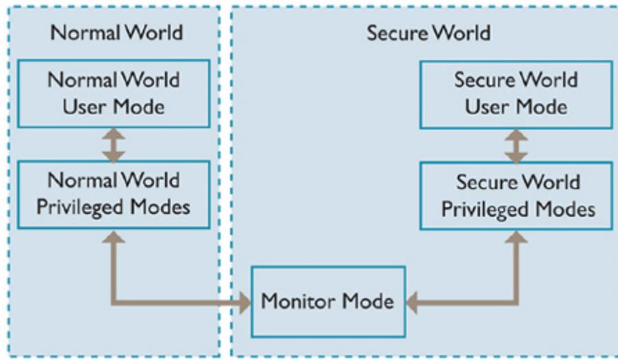
可通过以下方式确保系统安全：隔离所有SoC硬件和软件资源，使它们分别位于两个区域（用于安全子系统的安全区域以及用于存储其他所有内容的普通区域）中。支持TrustZone的AMBA3 AXI<sup>TM</sup>总线构造中的硬件逻辑可确保普通区域组件无法访问安全区域资源，从而在这两个区域之间构建强大边界。将敏感资源放入安全区域的设计，以及在安全的处理器内核中可靠运行软件可确保资产能够抵御众多潜在攻击，包括那些通常难以防护的攻击（例如，使用键盘或触摸屏输入密码）。通过在硬件中隔离安全敏感的外设，设计人员可限制需要通过安全评估的子系统的数目，从而在提交安全认证设备时节省成本。
