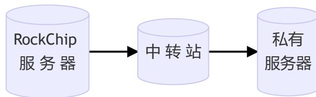
维护两套代码: 一个中转站, 一个开发用。这中转站作用是与Rockchip的服务器同步代码后, 把差异部分代码搬到服务器上; 这也是与Rockchip核对代码版本的参照物。服务器的作用, 可以根据使用习惯个性化。这样有两个好处:
