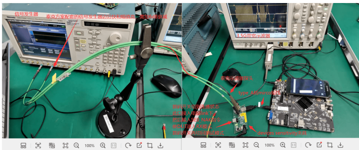
图 13 Tektronix USB 2.0 Rx 测试连接
